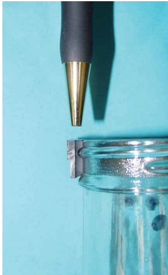
O inserto com projeto ideal irá envolver a rosca sem contato. O suporte é fornecido embaixo da rosca durante a remoção da garrafa.
