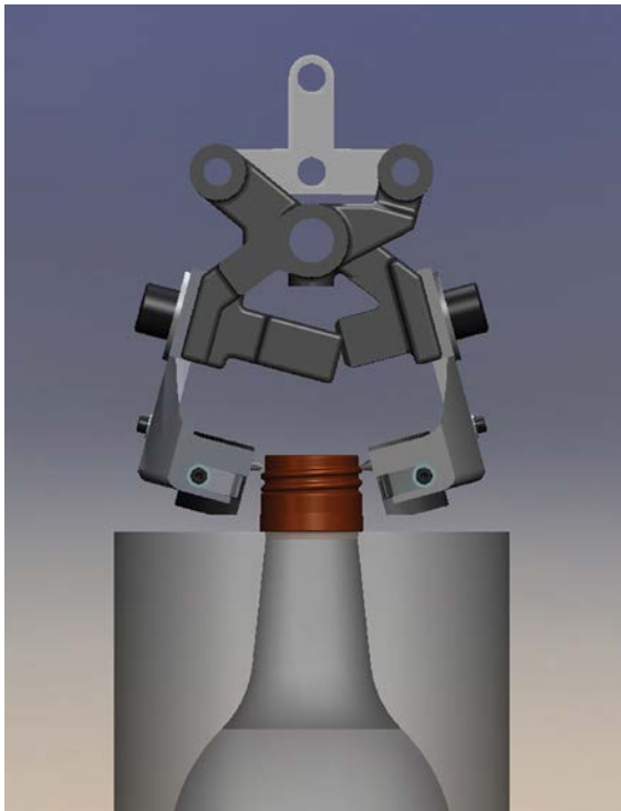
O suporte POCO de autoajuste, com um inserto GM de coleta de rosca, começa a fechar
