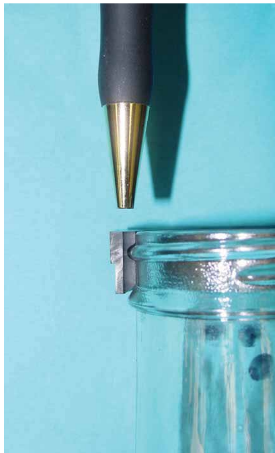
Вставка оптимальной конфигурации охватывает резьбу без контакта. При извлечении бутылки захват осуществляется под резьбой.
