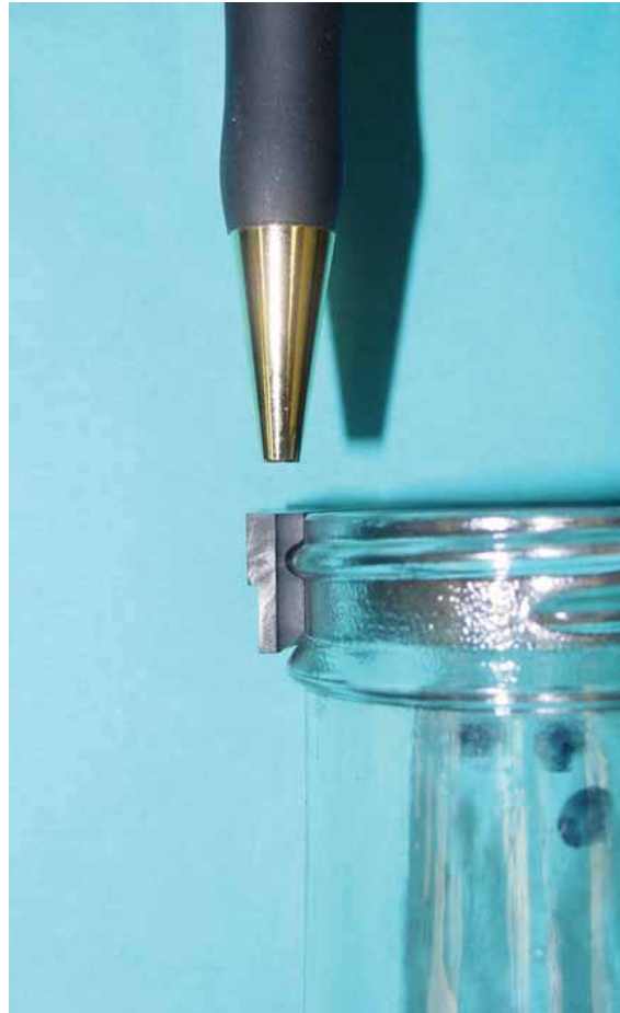
Un inserto con un diseño óptimo encapsulará la rosca sin ejercer contacto. Durante la extracción de la botella, el apoyo se proporciona bajo la rosca.
