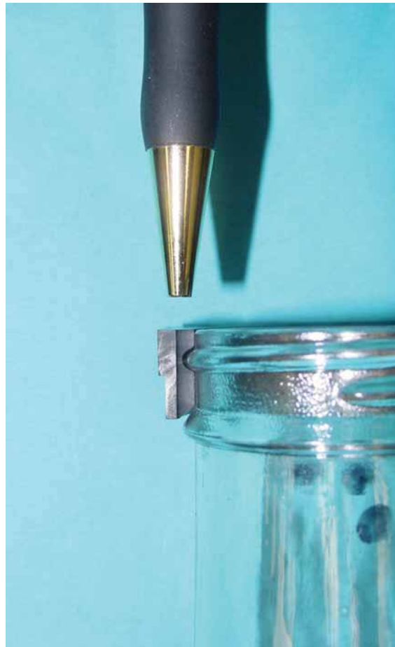
L'insert bénéficiant d'une conception optimale encapsulera le filetage sans le toucher. Un support est placé sous le filet durant le retrait de la bouteille.
